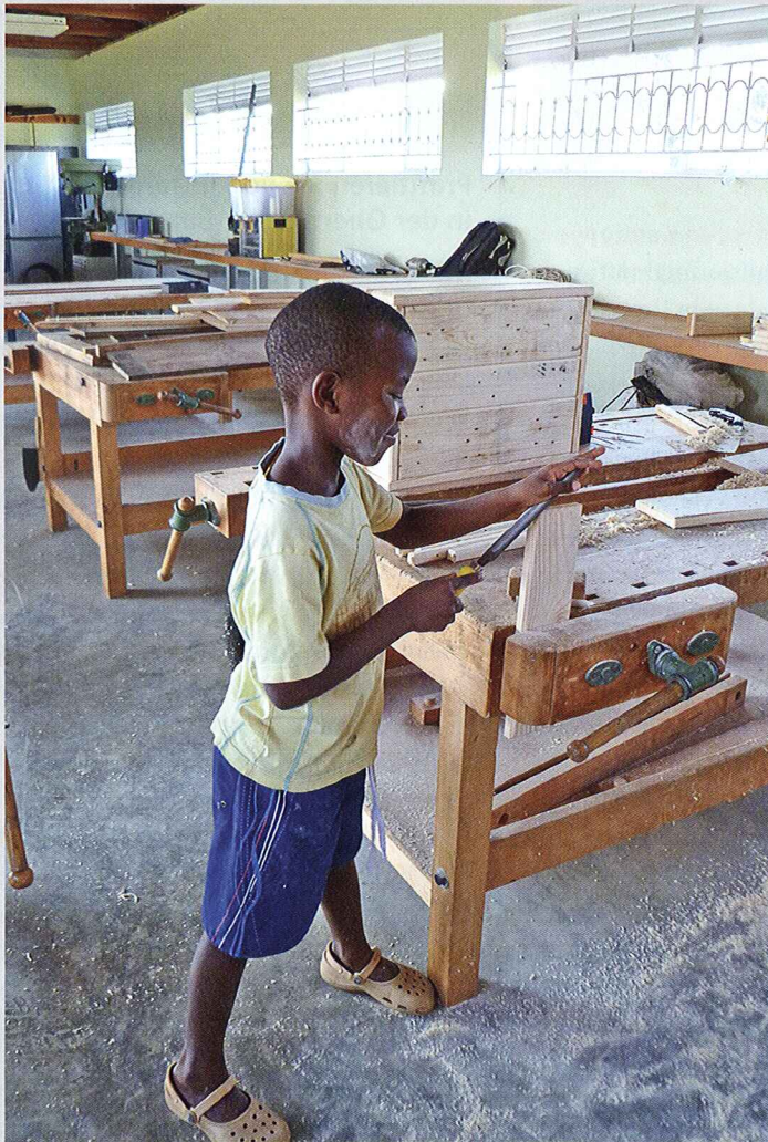
Benji rundet mit einer Feile die Kanten einer Seitenwand für eine Holzkiste/Harasse ab.
